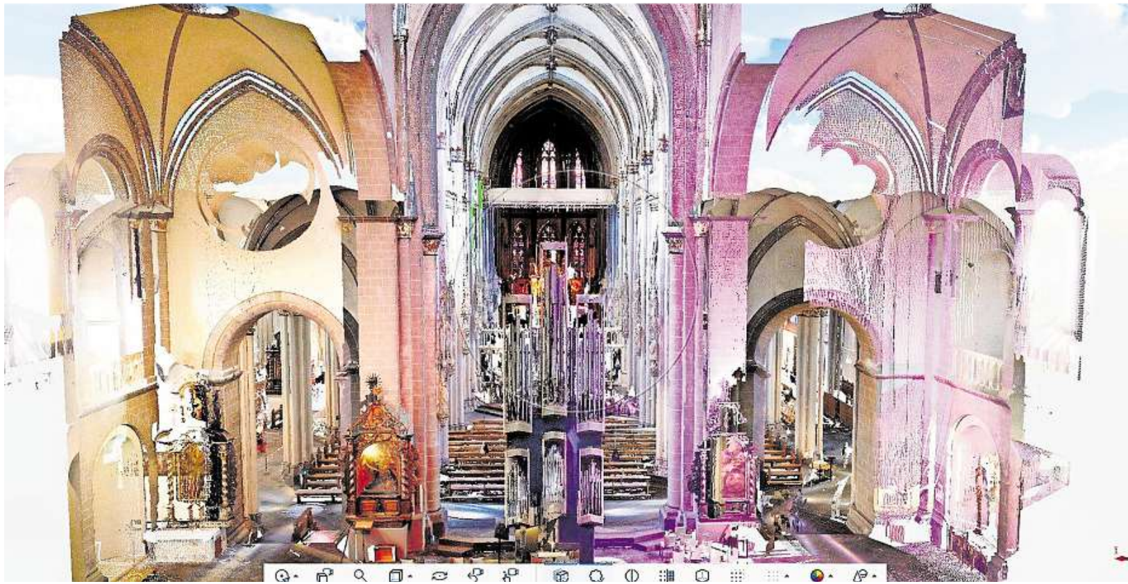
Diese Aufnahme vom Inneren des Doms ist mithilfe des Laserscannings entstanden, wobei Millionen von Punkten pro Sekunde erfasst werden und so eine echtfarbige dreidimensionale Punktwolke erzeugt wird.
